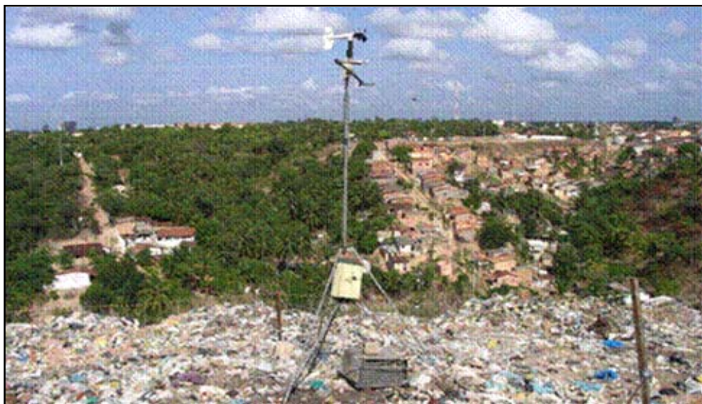
Figura 5 - Vista da Estação Meteorológica Automática (EMA) instalada no lixão de Maceió-AL.
